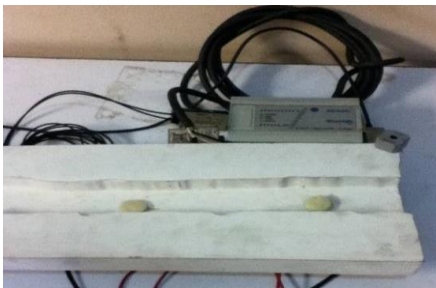
Figura 6 Instalación de sensores en fixture
